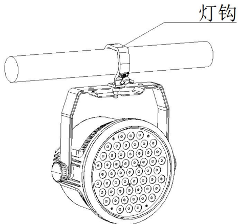
图（4.2-1）：灯钩悬挂安装
