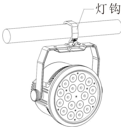
图（4.2-1）：灯钩悬挂安装
