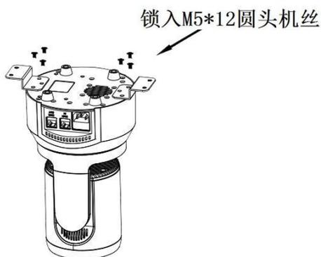
2、天花板与产品安装：①在灯具安装处使用木板加固处理。②根据需要在天花上开出线孔。③将天花开孔处穿出的网线及电源线插入产品对应接口。④调整产品安装方向后将产品固定到天花板上。如图所示；
